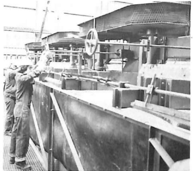
La primera celda, derecha es la N° 6, correspondiente a Pb. Las 2 últimas, celdas N° 7 y 8 producen concentrado de Zn.
