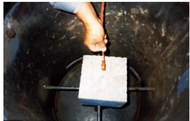
Figura 5.: Colocación del PETN en el centro del block
