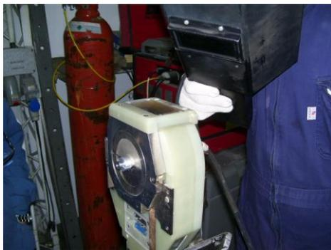
Figura 2. Equipo de soldadura orbital.
