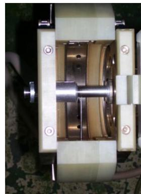
Figura 3. Piezas a soldar y electrodo.
