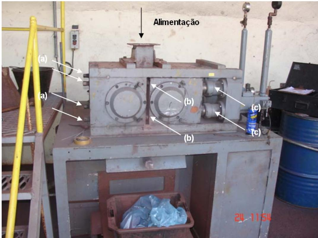
Figura 2. Prensa de rolos Polysius usada nos testes. (a) parafusos para ajuste da posição dos batentes (gap 0); (b) batentes separando as carcaças dos rolos móvel e fixo, lado esquerdo; (c) pistões do rolo móvel, lado esquerdo.
