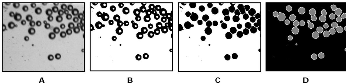
Figura 2. Principais etapas do processamento das imagens. (A) maximização do contraste; (B) limiarização (*threshold*), (C) *fill holes* + segmentação (*watershed*), (D) aplicação de filtros morfológicos e análise da imagem.
