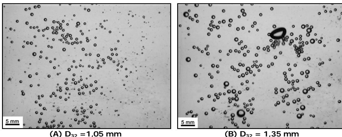
Figura 5. Imagens capturadas para diferentes razões ar/líquido ( $R_{A/W}$ ). Condições experimentais: Pressão = 4,2 kgf/cm<sup>2</sup>, [Flotanol M] = 5 mg/L.  $R_{A/W}$ : (A) 0,7, (B) 4,5.
