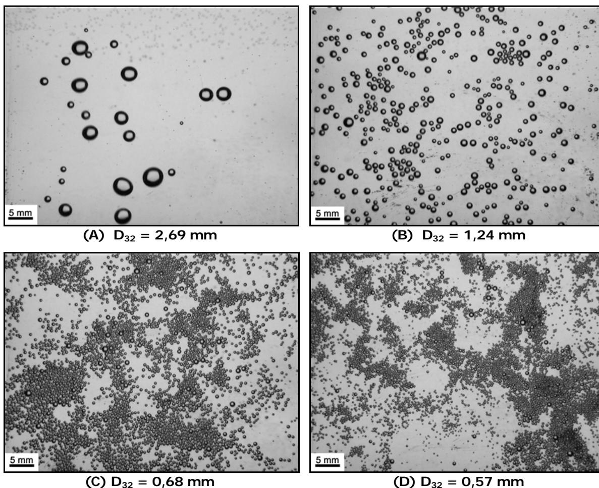
Figura 4. Imagens capturadas para diferentes concentrações de Flotanol M. Condições experimentais: Pressão =  $4,2\text{ kgf/cm}^2$ ;  $Q_{AR} = 3,75\text{ L/min}$ ;  $R_{A/W} = 2,8$ . [Flotanol M]: (A) 0 mg/L, (B) 5 mg/L, (C) 10 mg/L, (D) 20 mg/L.
