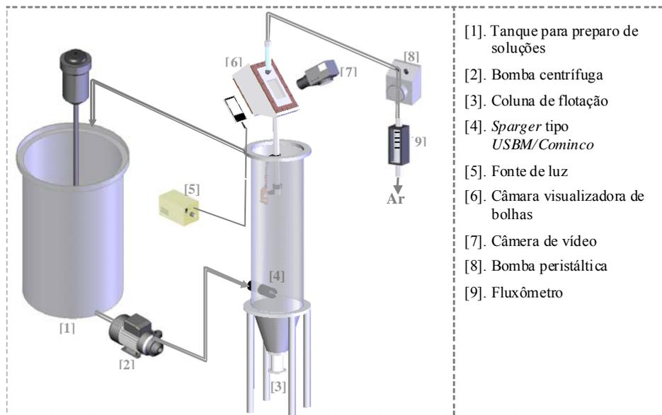
Figura 3. Montagem experimental.
